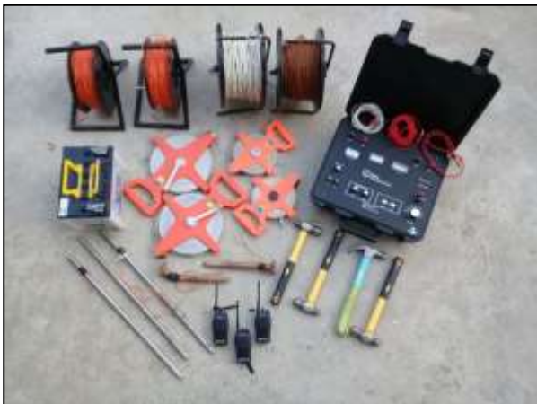
Gambar 5. Resistivity Meter IRES T300f beserta aksesoris.
